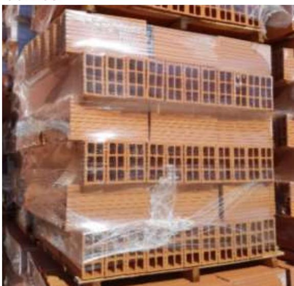
Figura 5 un "Pallet" del 8 (198 ladrillos 8/18/33 sobre pallet liviano)
