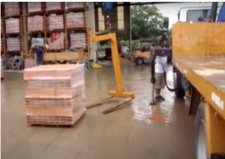
Figura 2 Camión moviendo ladrillos a través de hidro grúa
