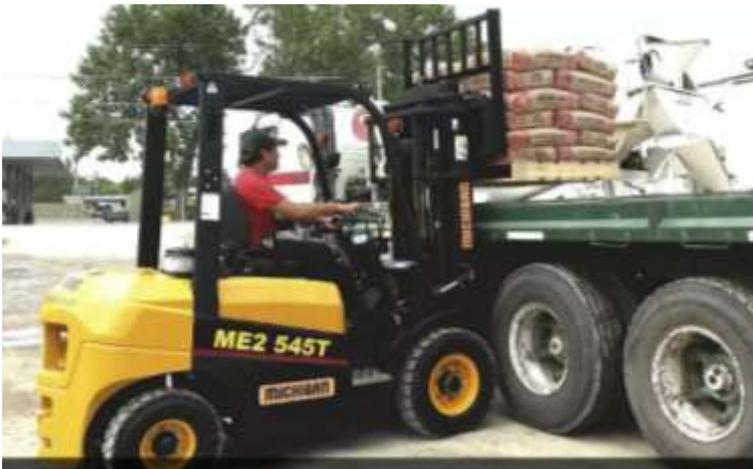
Figura 1 maquina autoelevadora cargando con pallet un camión
