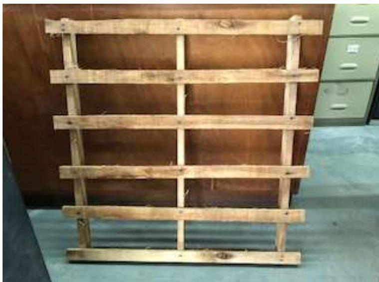
Figura 4 Pallet liviano usado en embalaje de ladrillos
