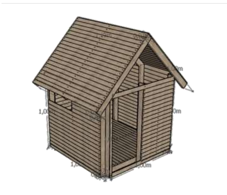
Figura 7 agregamos el techo realizado con dos paneles ciegos
