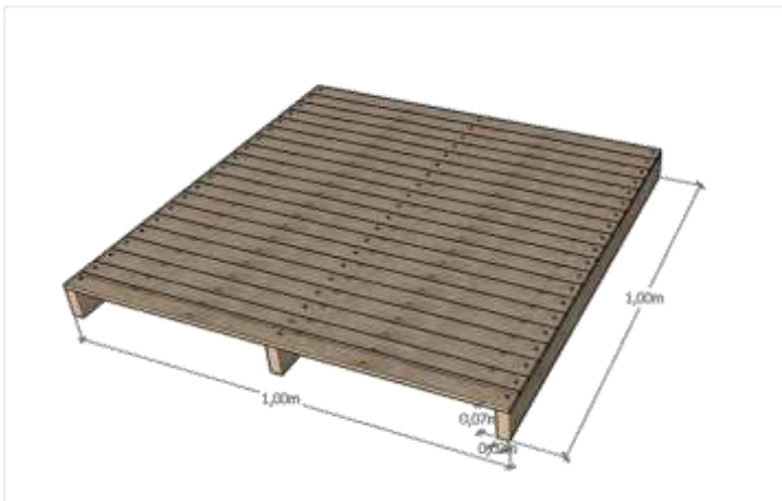
Figura 3 base de la casita, un pallet cubierto de tablillas
