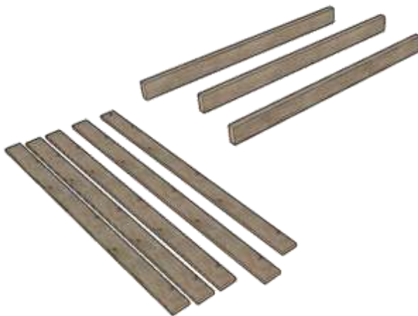
Figura 2 listones de 1 ½' x 3" y tablillas de 2"x ¾" obtenidos de un pallet liviano
